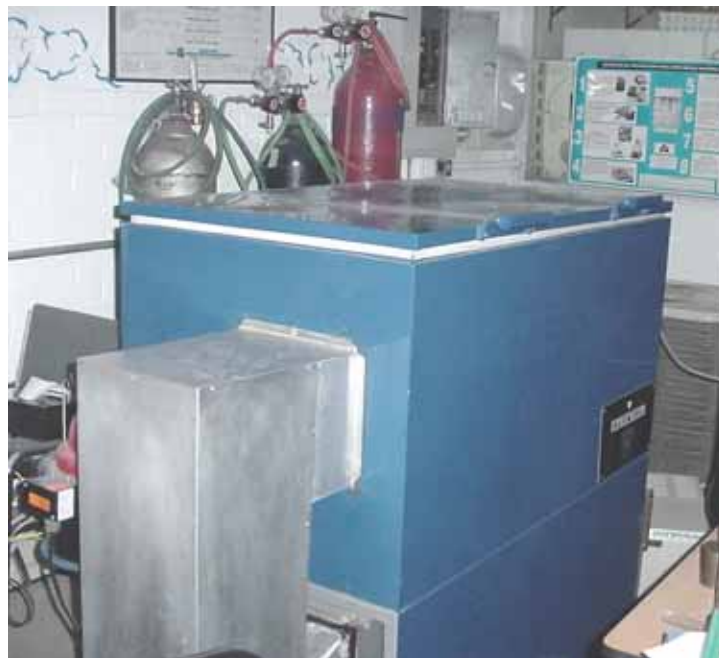
Figura 4.2 Cámara para ensayos acelerados de corrosión
