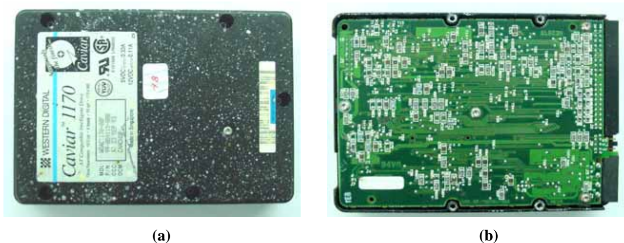
Figura 4.20 (a) En lo que respecta a la carcasa son notorias las marcas de condensado. (b) A diferencia del disco duro mostrado en la imagen anterior, en este caso la tarjeta controladora se encuentra en posición invertida, solo se observan los circuitos impresos.
