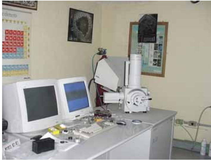
Figura 3.3 Microscopio Electrónico de Barrido Phillips XL20 (SEM) equipado con un detector Eberthard - Thornly estándar y un detector de electrones retrodispersados de estado sólido.
