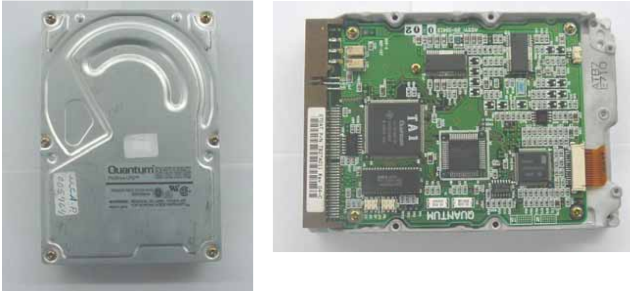
Figura 3.6 Apariencia de disco duro tanto de la carcasa como de la tarjeta electrónica, (dispositivo diagnosticado con falla mecánica).
