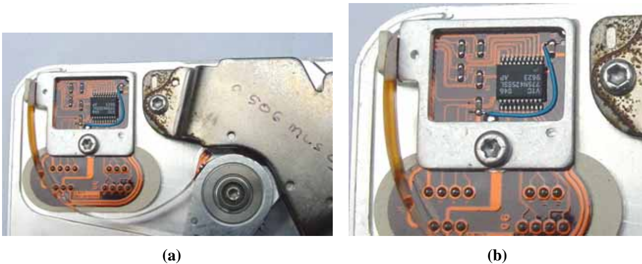
Figura 4.9 (a) Elementos internos que componen al disco duro. (b) En esta imagen no se observa deterioro en los circuitos integrados, ni en pistas.
