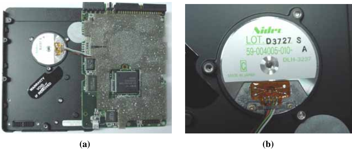
Figura 4.22 (a) Al destapar la tarjeta controladora del disco, se aprecia que los componentes electrónicos están cubiertos por una esponja cuya función es proteger dichos elementos. (b) En la parte que conecta a la tarjeta con el actuador del disco, en terminales de conexión y soldadura de estos elementos, no se aprecia deterioro alguno.
