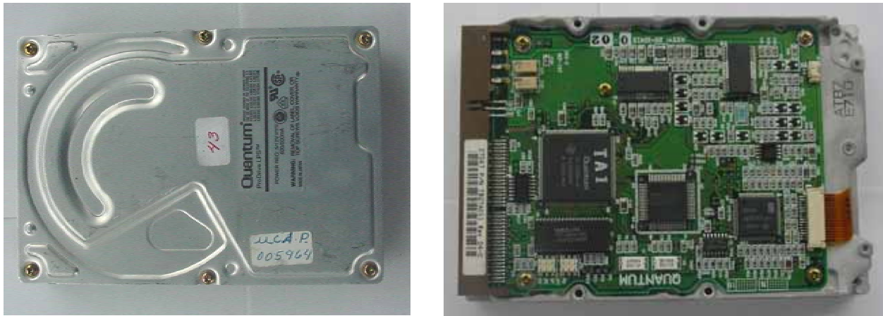
Figura 4.4 (a) Aspecto de la carcasa del disco duro. (b) Componentes electrónicos de la tarjeta controladora del disco, este dispositivo se someterá al ensayo sin protección en pinos.
