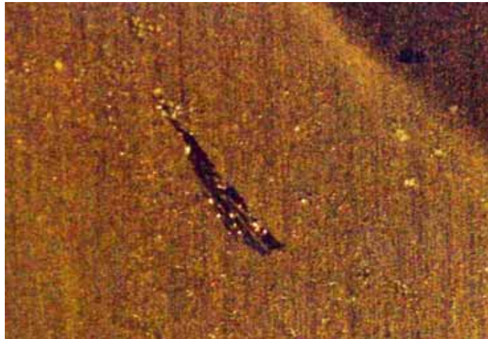
Figura 3.11 En la imagen se aprecia claramente el desprendimiento de material de la superficie del disco provocado por la cabeza de lectura/escritura.
