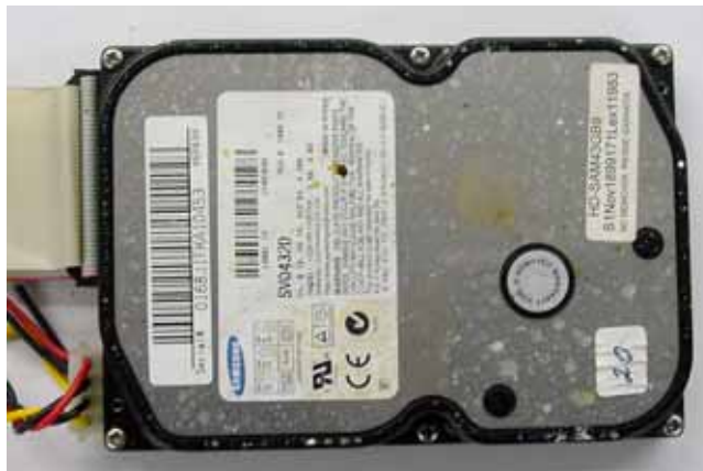
Figura 4.18 Apariencia de discos duros después de haber sido sometidos a la prueba de simulación acelerada por corrosión.
