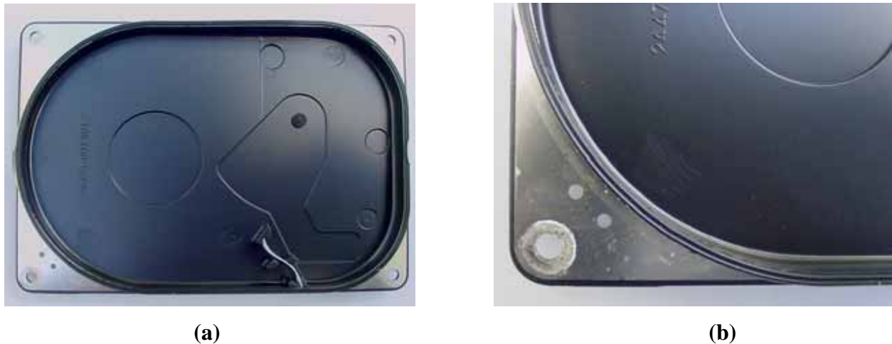
Figura 4.11 (a) Tapa del Disco duro, en general se encuentra en buenas condiciones. (b) En los barrenos se pueden apreciar marcas de condensado así como escurrimientos del mismo.
