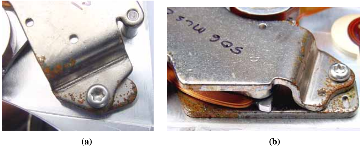
Figura 4.10 (a) En el soporte del actuador es evidente la existencia de corrosión en su estructura. (b) En esta imagen, al tener una mayor amplificación, es más evidente el deterioro sufrido por corrosión en este elemento.
