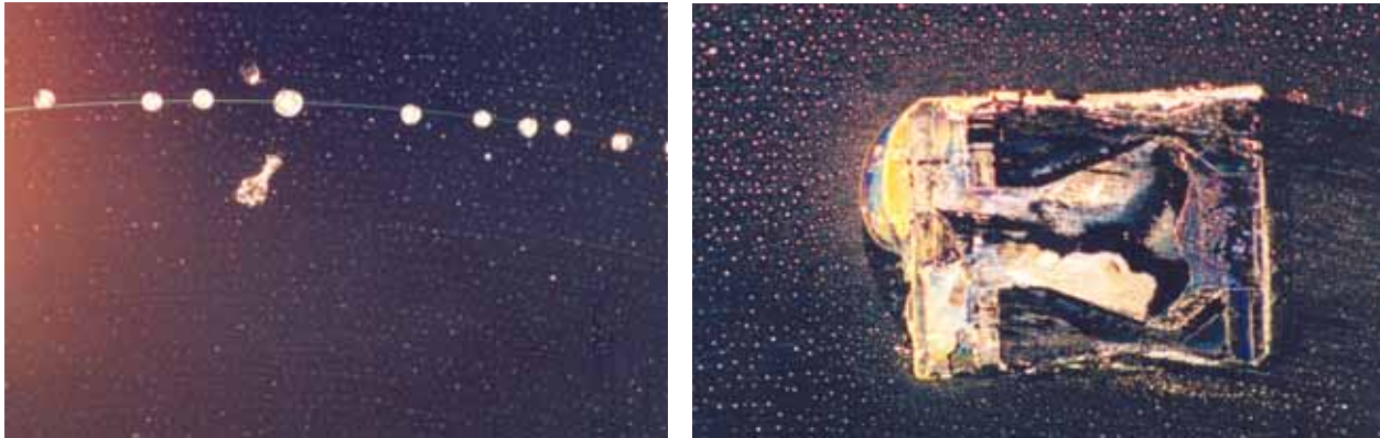
Figura 4.14 (a) Marcas de condensado sobre la superficie notándose discontinuidad en la capa de carbono. (b) Uno de los problemas encontrados después del ensayo fue la adherencia de la cabeza de lectura/escritura al plato, en este caso se tiene la marca del desprendimiento de la misma sobre la superficie del disco. Esto sugiere la conveniencia de la inspección a detalle de la cabeza de lectura/escritura.
