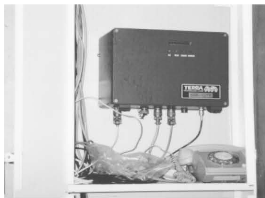
FIGURA 5.1.1. Acelerógrafo tipo usado para el registro de señales de vibración ambiental
