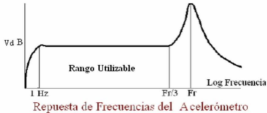
FIGURA 5.1.3. Respuesta de Frecuencias del Acelerómetro
