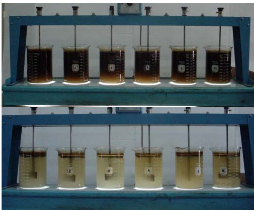
Figura 3.3 Agua residual antes y después de las pruebas de jarras.
