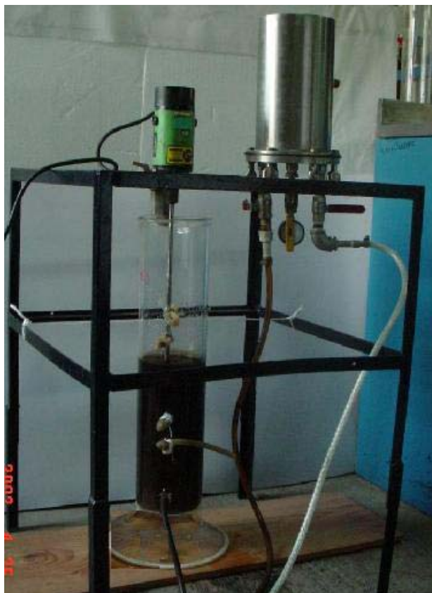
Figura 3.10. Equipo experimental para las pruebas de flotación.
