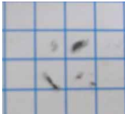
Fotografía 7.13 Partículas acumuladas en el reten del cojinete
