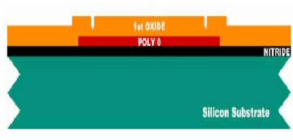
La oblea es cubierta con fotoresistivo y la macara DIMPLES es grabada por litografía. Los DIMPLES tiene una profundidad de 0.75 [µm], son grabados por RIE en la primera capa de óxido. Después del grabado el fotoresistivo es removido.
