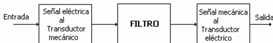
Figura 1.16. Diagrama de bloques de un filtro electromecánico.
