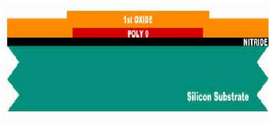
Una capa de 2µm de PSG es depositada en la oblea por deposición de vapor químico a baja presión (LPCVD). Esta es la primera capa de sacrificio.
