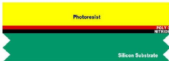
Se deposita una capa de 0.6 [ $\mu\text{m}$ ] de óxido de silicio aislante sobre un sustrato de silicio tipo N(100). En seguida se deposita 0.5 [ $\mu\text{m}$ ] polisilicio (poly0). La oblea se cubre con un fotoresistivo sensible a la luz ultravioleta (UV).
