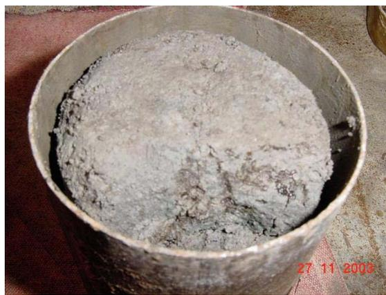
Fotografía 3.2.10. Muestra 3 se localizan las manchas, y cambios en la coloración del suelo por el contaminante
