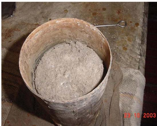
Fotografía 3.2.1. Muestra 1, se aprecian las condiciones del tubo y la forma en se realizó el labrado de la muestra
