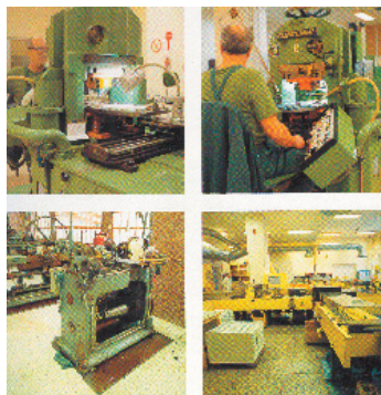
Fig. 1.5. Máquinas impresoras y cortadoras de billetes.
