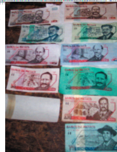
Fig. 3.15. Pruebas de color y tinta durante el proceso de impresión de los billetes del Libro A.
