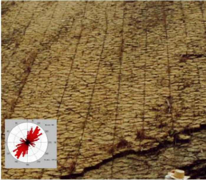
**Fig. I.3 Las areniscas de Chicontepec muestran una red compleja de fracturas naturales sistemáticas y no sistemáticas en el afloramiento y en las orientaciones de los núcleos subsuperficiales, como fue determinado en las pruebas microsísmicas.**
