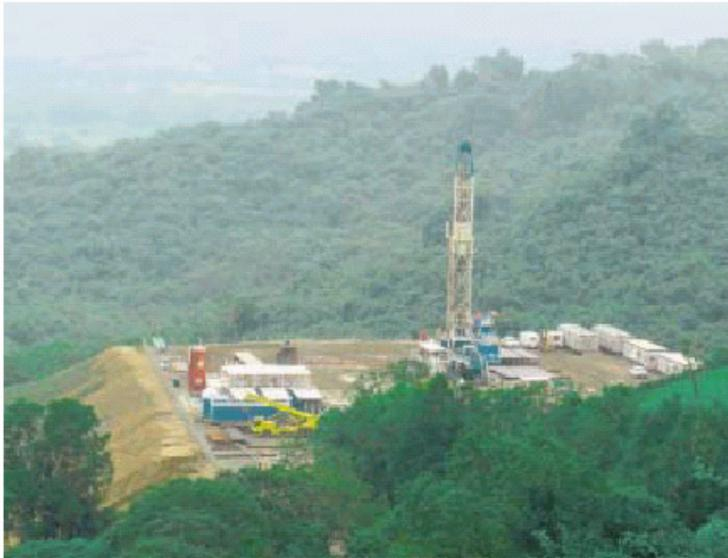
**Fig. I.11 Equipo de perforación del Paleocanal de Chicontepec, construido para optimizar los tiempos y logística de perforación, en localizaciones de pozos múltiples.**
