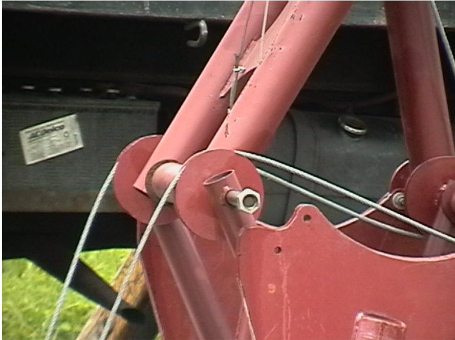
Fig. 6.35 La geometría final se tiene cuando el perno trasero de la primera tijera llega al apoyo y se asegura en la base
