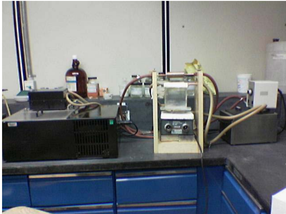
Figura D-1: Fotografía del modelo experimental que se empleó en la penetración capilar en una celda de Hele-Shaw. A la derecha se muestra el baño térmico HETE CB7, a la izquierda el baño térmico HAKE C10, en el centro se observa el modelo experimental.
