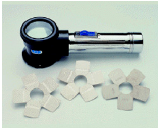
INSTRUMENTOS MEDIDORES DE PERFIL DE ANCLAJE DE SUPERFICIES LIMPIADAS CON CHORRO DE ARENA
