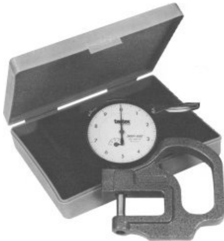
INSTRUMENTOS MEDIDORES DE PERFIL DE ANCLAJE DE SUPERFICIES LIMPIADAS CON CHORRO DE ARENA
