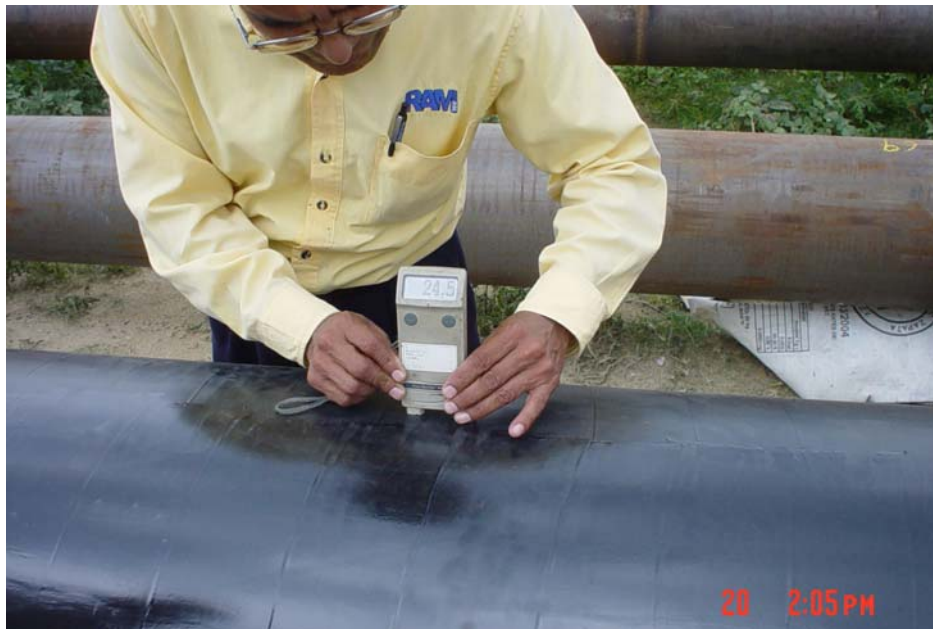
MEDIDOR DE LECTURA DIRECTA TIPO MAGNÉTICO PARA VERIFICAR EL EPESOR DE LA CAPA DE RECUBRIMIENTO SECO
