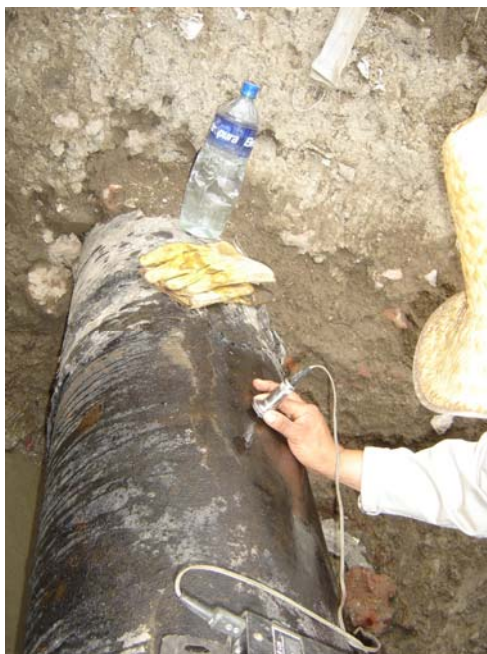
CALIBRACIÓN (MAPEO) CUADRICULADA PARA DETERMINAR LA TUBERÍA SANA
