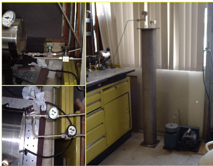
Figura 4.2. Sistema de gases ATR-SPR. A la derecha aparecen la celda de gases que contiene la mezcla de n-dodecano y la bomba de vacío mecánico. A la izquierda aparecen dos fotos de las válvulas de gas utilizadas para control de flujo de gases.
