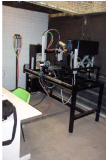
Fig. 4.3 Sistema semiautomatizado de proyección térmica por flama
