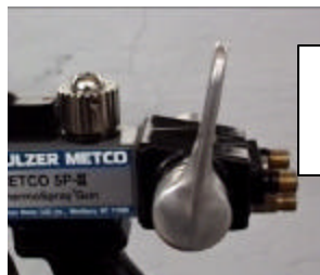
Fig. 2.7 Válvula de gas completamente cerrada
