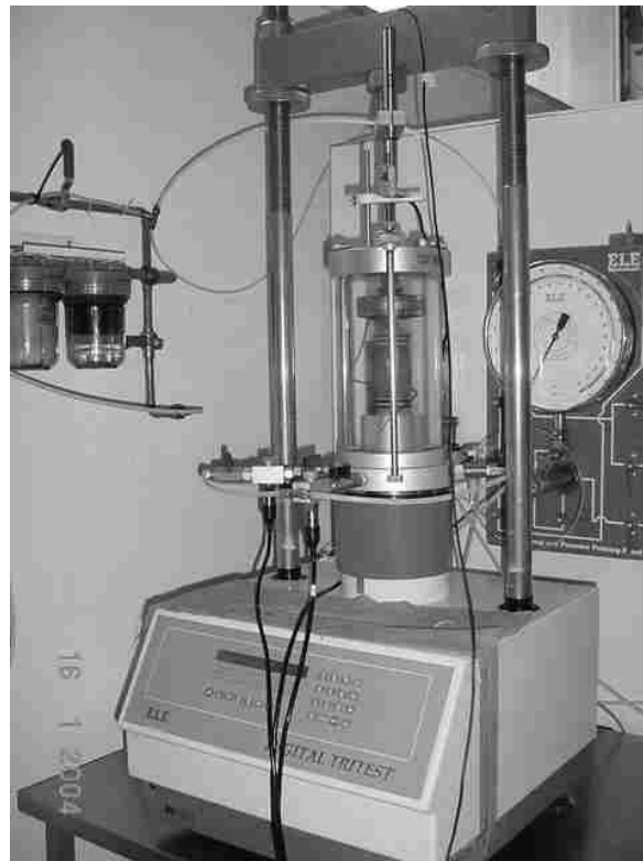
Fig. 3.6 Marco de carga digital Tri Test 100 Laboratorio de Dinámica de Suelos. Facultad de Ingeniería. UNAM.
