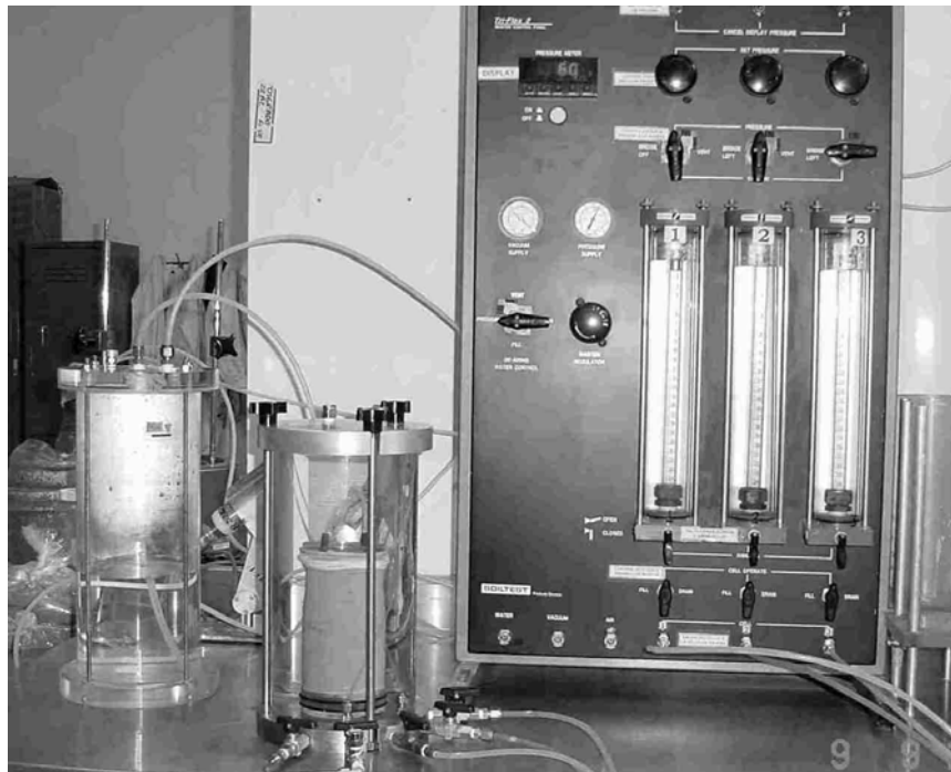
Fig. 3.1 Permeámetro de Paredes Flexibles Tri – Flex Laboratorio de Dinámica de Suelos. Facultad de Ingeniería. UNAM
