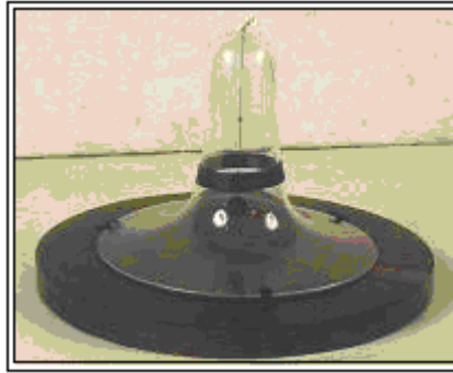
figura 1.6 Inclinómetro instrumento diseñado por Leonardo para controlar la posición de las máquinas en el aire.
