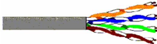
Figura 1.8 Estructura del cable par trenzado.
