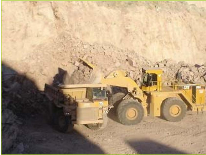
*Fotografía III.5. Carga del material.*
