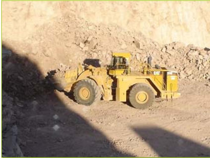
*Fotografía III.3. Extracción de material con cargador frontal*
