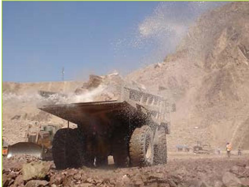
*Fotografía III.6. Humectación del material antes de ser depositado.*
