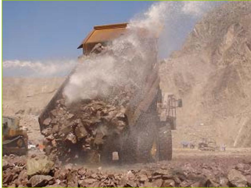
*Fotografía III.7 Descarga del material mientras sigue siendo humectado.*
