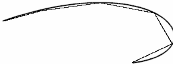
Fig. 3.1 Aproximación de una curva por una poligonal.
