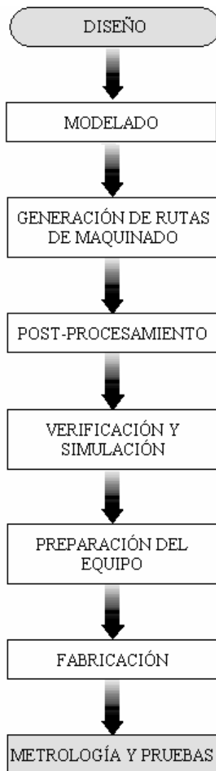
Fig. 5.1 El diagrama muestra la secuencia del proceso de fabricación por control numérico, las etapas en color gris no están incluidas dentro del procedimiento.
