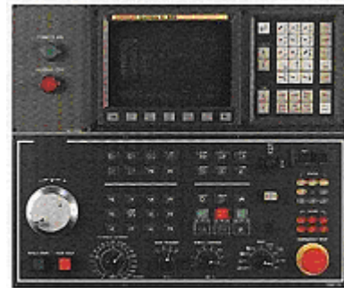
Fig. 4.6 Panel de Control Fanuc serie OMD
