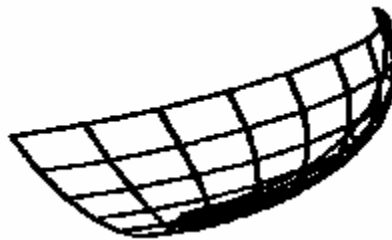
Fig. 3.3 Superficie formada por curvas isoparamétricas.
