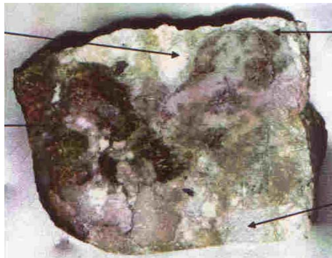
Figura 3.4. La muestra corresponde a la brecha calcárea del límite Cretácico Superior – Terciario y presenta diversos eventos de fracturamiento impregnadas de aceite pesado, vúgulos, estilolitas y clastos. a) Núcleo del pozo Cantarell 3001 y b) Núcleo del pozo Cantarell 2084.
