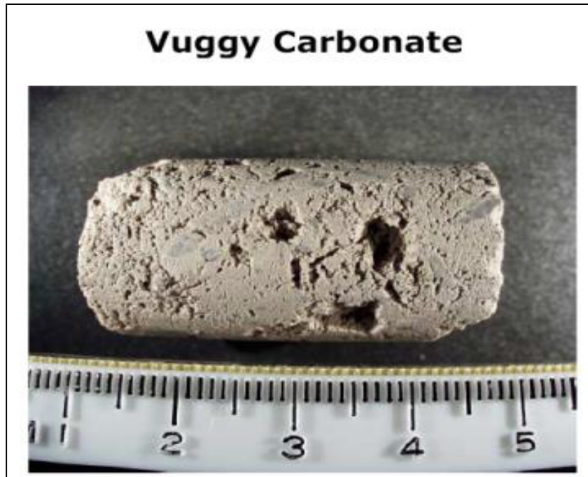
Figura 3.2. Núcleo de la brecha calcárea del límite Cretácico - Terciario, se observa la porosidad, cavidades de disolución y fracturamiento.
