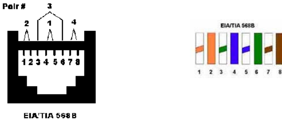
Fig. 2.21 – Código de colores en un conector de pared (jack) en base a Norma 568B
