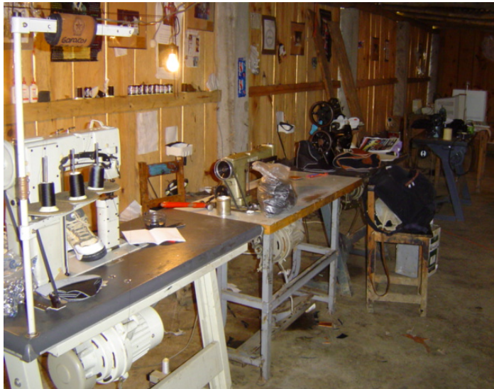
Taller del Arte del Calzado de Oventic cuenta con cinco máquinas de coser; desde la más sencilla que fue con la que iniciaron los trabajos hasta una completamente industrial (izquierda).
