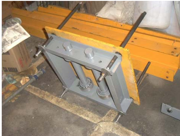
APOYOS MÓVILES INCORPORADOS A PLACAS FOTOGRAFÍA 4.3
