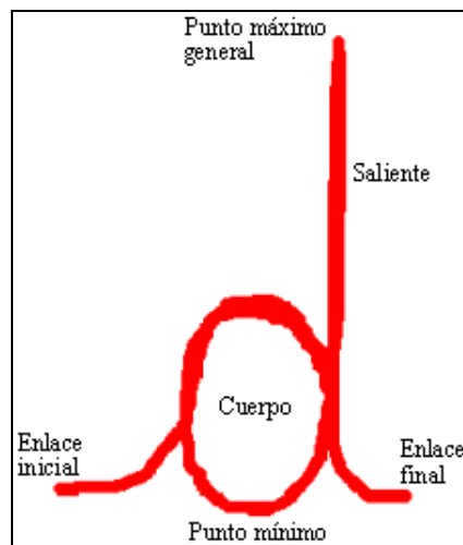
Figura 4.20. Cuerpo, enlaces, puntos mínimo y máximo general, y saliente en un carácter alto
