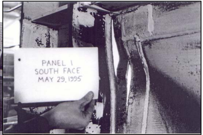
Fig. I.2-8. Desgarre del panel 1, formado durante el ciclo 18 (Driver et al; 1996)
