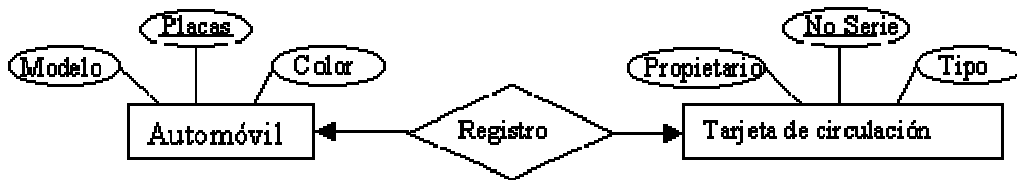
Figura 2.2 En esta relación uno a uno, los atributos de la entidad “Automóvil” son el modelo, la clave de las placas y el color. Para “Tarjeta de circulación” los atributos son el propietario, el número de serie y el tipo. Ambas entidades están relacionadas por el registro vehicular y se considera una relación uno a uno porque un auto sólo tiene una tarjeta de circulación y una tarjeta de circulación sólo pertenece a un automóvil.
