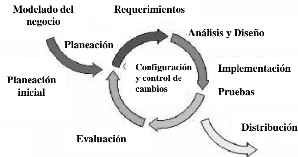
Figura 3.4 Cada iteración realizada en un flujo de trabajo RUP comienza con el modelado del negocio y la planeación inicial, pasa por el estudio de requerimientos, análisis y diseño, implementación y pruebas, continuando este ciclo hasta que las pruebas se superan y se pasa a la distribución.
