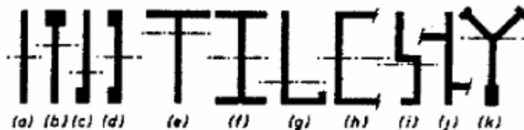
Fig. 2 Secciones transversales comunes de muros estructurales.
