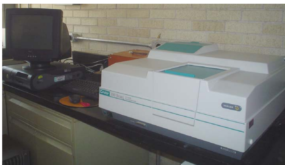
Figura 1.19. Equipo de espectroscopia UV-Visible. El equipo consiste en una lámpara incandescente de tungsteno, un monocromador, un fotómetro (divide el haz), celdas de muestra y de referencia; y detector del haz transmitido.
