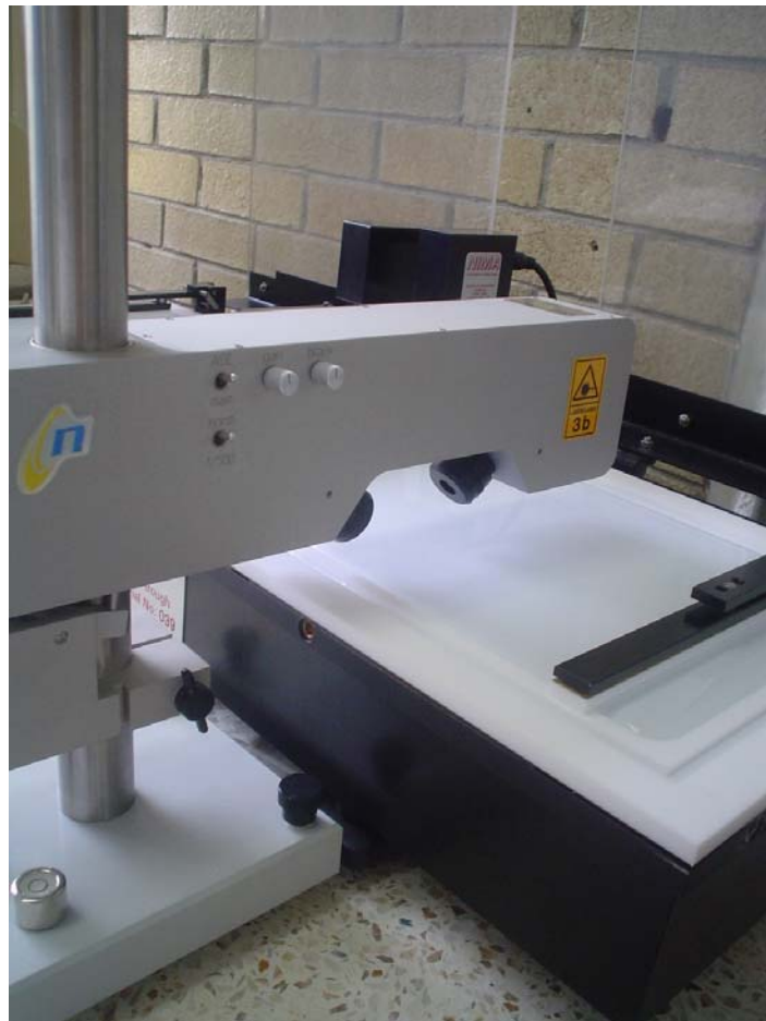
Figura 2.7 Equipo miniBAM acoplado a la cuba de Langmuir Blodgett
