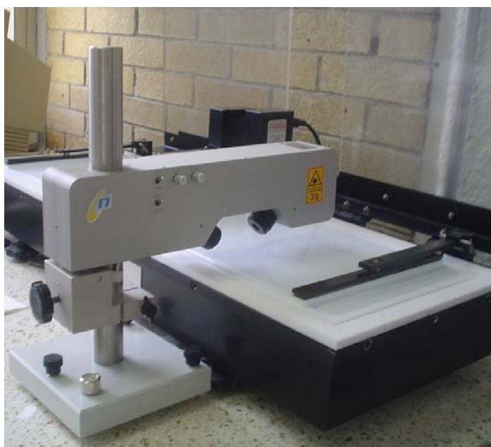
Figura 1.18. Equipo BAM acoplado a la cuba de Langmuir.
