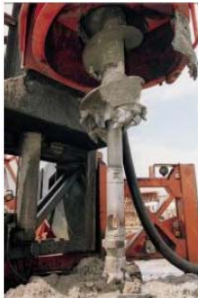
Figura V.1 Detalle del taladro rotatorio equipo Starsol
