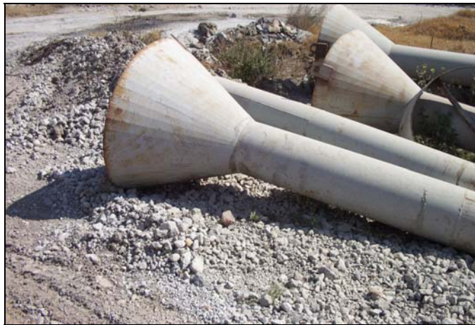
Figura V.10 Equipo utilizado para la colocación de la grava bien graduada al finalizar la inclusión.
