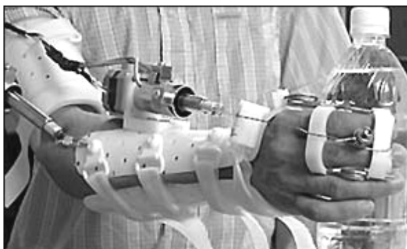
Figura 1.4 Prótesis de mano que se activa con la voz 12
