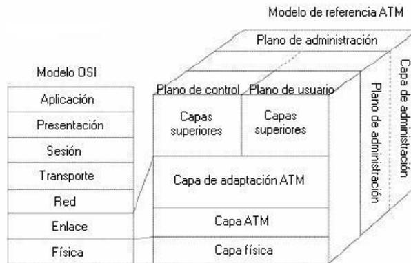
Fig. 2.9. Las funcionalidades de ATM abarcan la capa física y parte de la capa de enlace del Modelo OSI.
