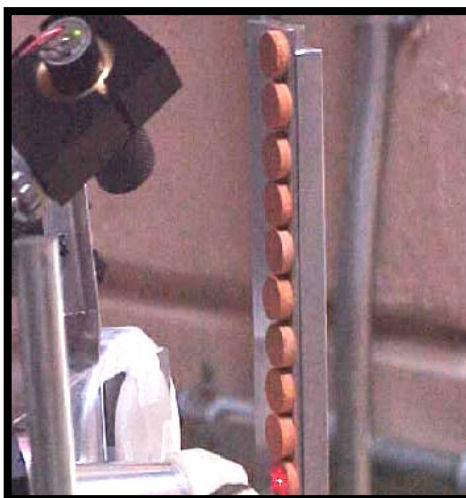
Figura 8: Haz de protones irradiando muestras de suelo en el acelerador de partículas Pelletron
