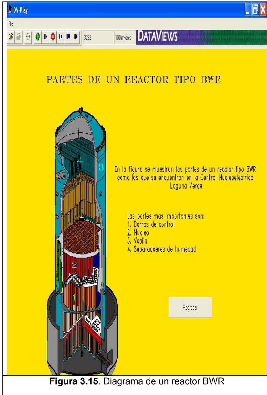
En otro despliegue se muestra el funcionamiento del reactor mediante la simulación de la extracción o inserción de las barras de control (Figura 3.16). El comportamiento de la potencia del reactor en función de la posición de las
