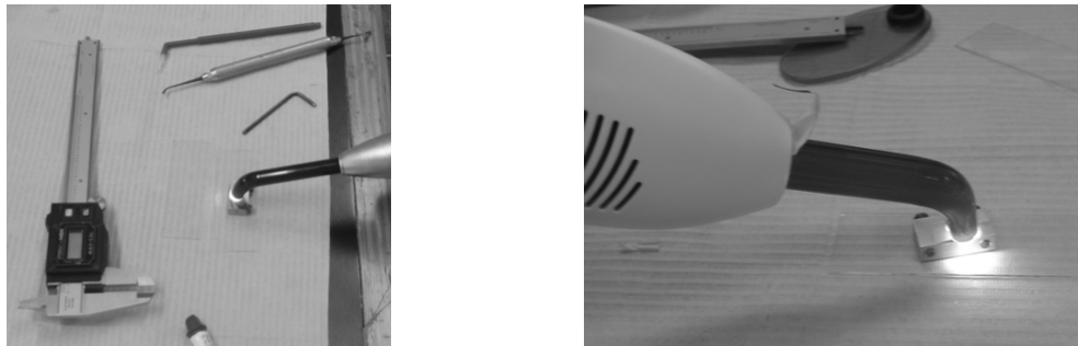
Fig. 14 proceso de la prueba de profundidad de curado.
