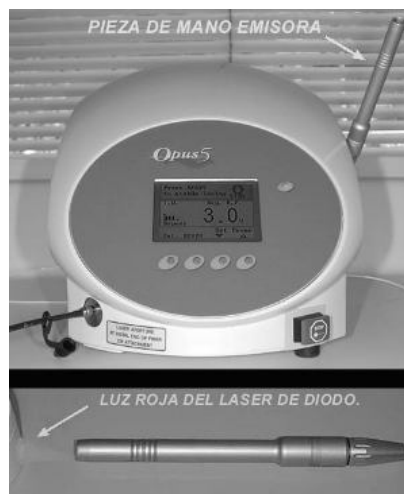
Fig. 6 ejemplo de una lámpara láser de diodo.
