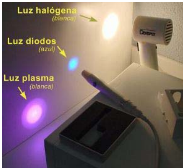
Fig. 2 Luz sin filtrar producida por lámparas de distinta tecnología.
