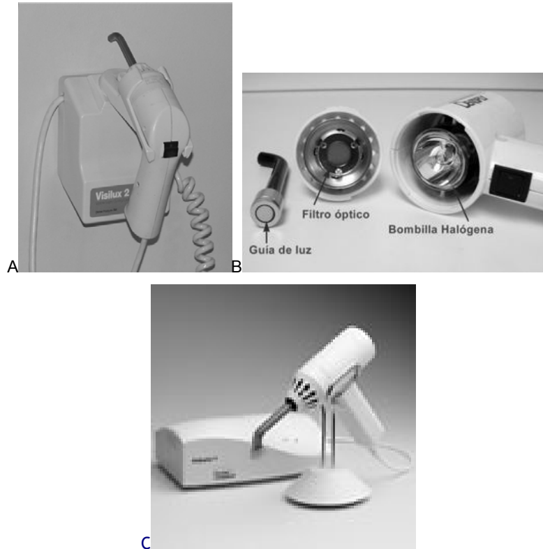
Fig. 3 A), C) Lámparas TLH y B) una vista en su interior, el ventilador se encuentra atrás de la bombilla.
