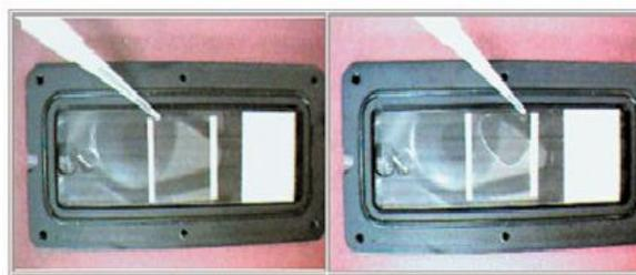
Figura 8. Cámara de hibridación OPERON, OPT's USA (OpArray<sup>®</sup>). Tomada de [www.operon.eu.com](http://www.operon.eu.com)
