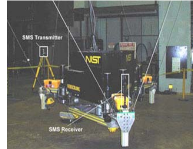
Fig. # 79. Robotcrane. Imagen tomada con fines académicos de: Development of a Robotic Structural Steel Placement System http://www.bfrl.nist.gov/
