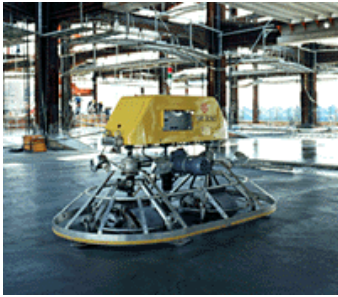
Fig. # 77. Robot afinador de concreto. Imagen tomada con fines académicos de: Development of a Robotic Structural Steel Placement System
