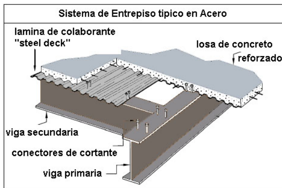
Fig. # 32. Sistema de Entrepiso Típico en Acero
