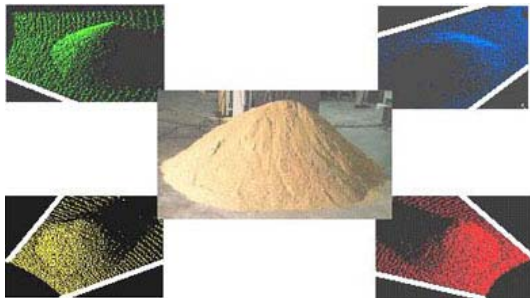
Fig. # 75. Visualización de elementos en el sitio de obra por medio de sensores láser. Imagen tomada con fines académicos de: Laser Scanning For Construction Metrology http://www.bfrl.nist.gov/
