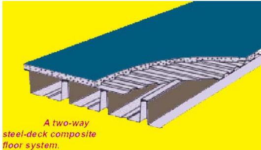
Fig. # 86. Entrepisos utilizados por Sistema "Staggered Truss". Two way steel deck
