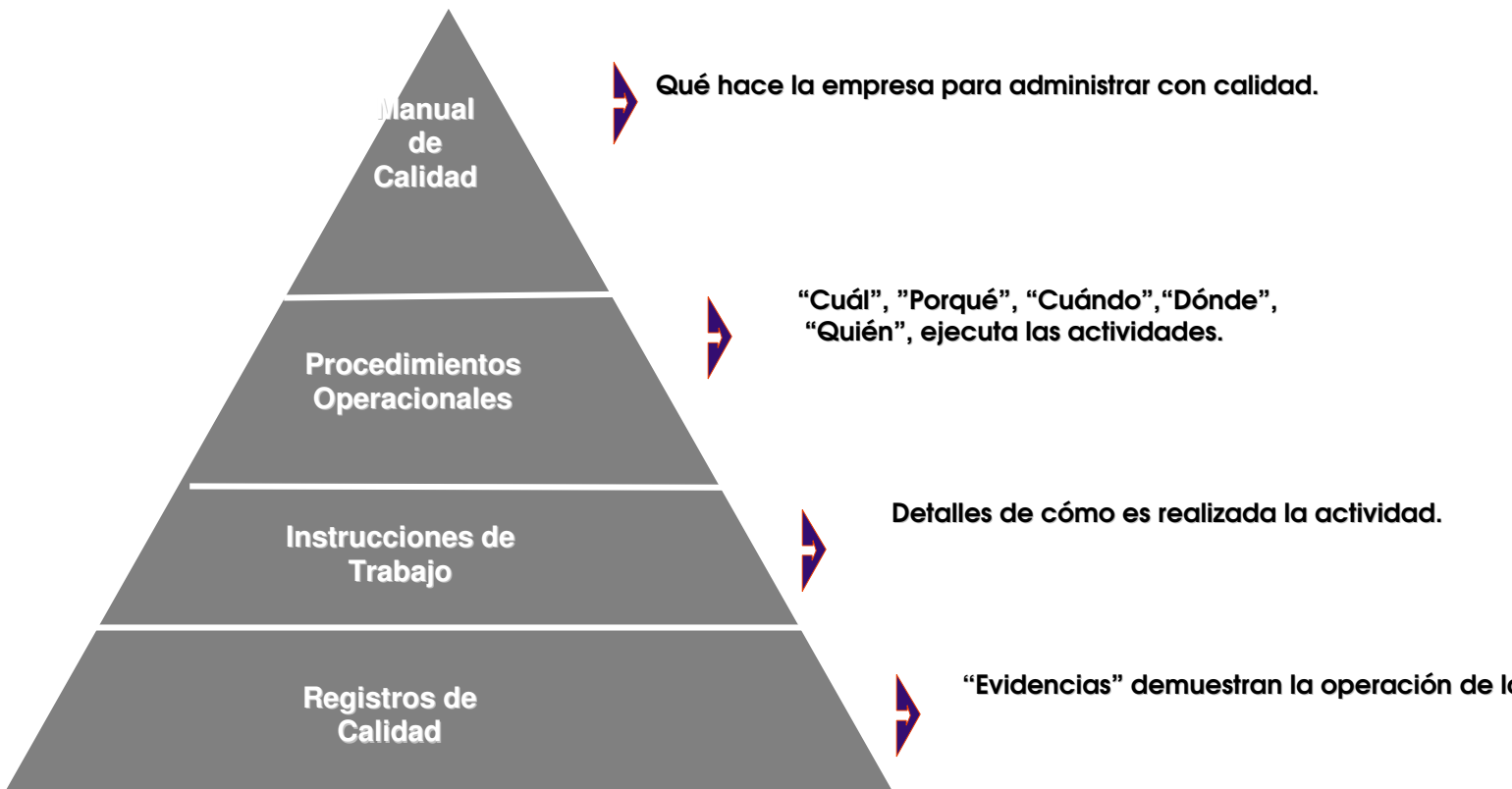
Figura No. 4. Jerarquía de los documentos del sistema de calidad, basado en los requisitos de la Norma ISO 9000
