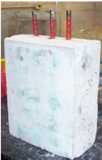
Figura 2.3, Corte transversal de una probeta de concreto armado y puntos de medición de potenciales.
