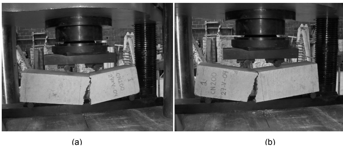
Fig. 4-23. Vigas ensayadas a flexión: a) espécimen 1, b) espécimen 2
