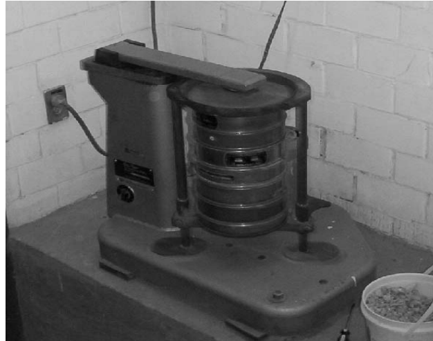
Fig. 2-4. Equipo utilizado para conocer la distribución de tamaños de todos los agregados
