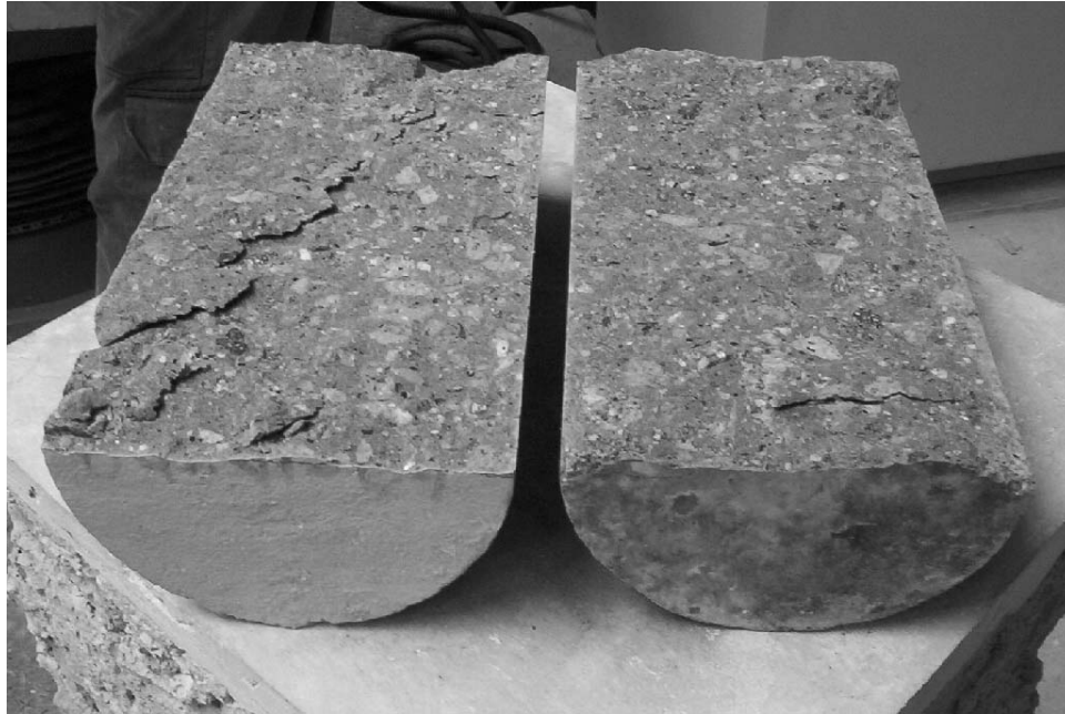
Fig. 3-4. Espécimen fallado a tensión por compresión diametral
