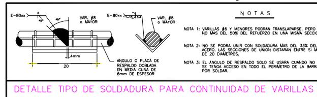
DETALLE TIPO DE SOLDADURA PARA CONTINUIDAD DE VARILLAS
