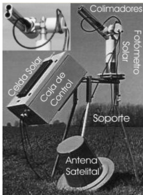
Fig. 3.1: En esta fotografía se muestran las partes principales del fotómetro solar CIMEL: antena satelital, celda solar, caja de control, soporte y colimadores.
