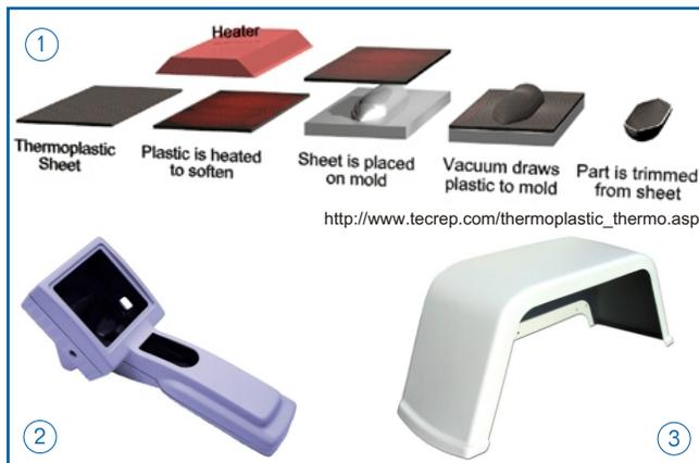
Imagen Superior Recuadro (1): Proceso de Termoformado. Imágenes Inferiores (2,3): Piezas diseñadas para ser producidas por proceso de termoformado con espesor y para carcasas.
