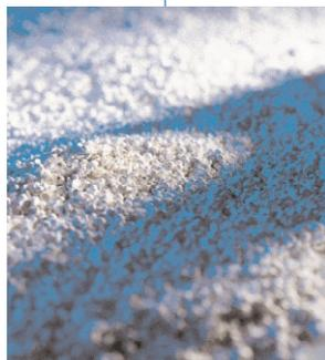
*La Cal Sodada con la cual está compuesto el absorbedor de  $CO_2$  se torna púrpura a medida que esta se satura de dicho compuesto, teniendo que renovarlo cuando este se satura.*
