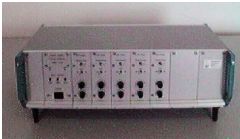
Fig. 11 Equipo de acondicionamiento de señales (amplificadores y filtros)
