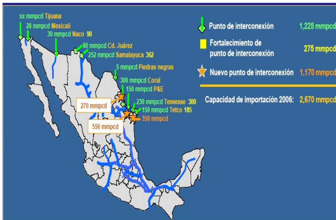
Figura A IV.4 Infraestructura de ductos para la importación de gas natural
