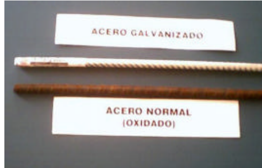
Fig. 3 13. Muestras de acero convencional oxidado y acero galvanizado.
