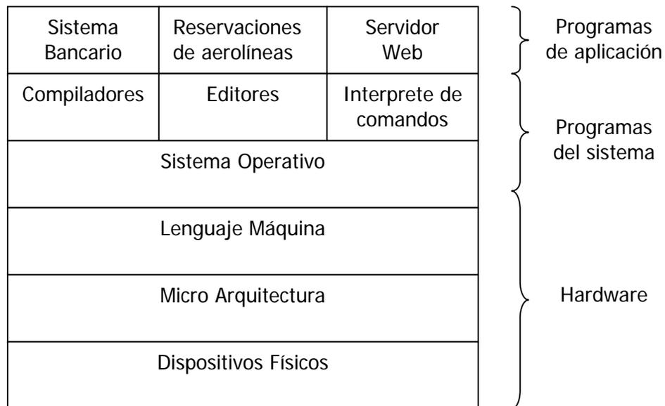
En la parte de inferior del diagrama encontramos al hardware, el cuál a su vez se encuentra compuesto por dos o tres niveles. El nivel más bajo esta formado por los dispositivos físicos, como son los circuitos integrados, cables, fuentes de poder, tubos de rayos catódicos y otros dispositivos más que son popularmente utilizados hoy en día.
