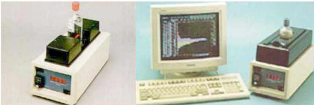
Fotografía 5. La imagen de la izquierda muestra el Contador Láser de Partículas Spectrex, sin la tapa oscura que lo protege de la entrada de partículas de polvo y luz. La imagen de la derecha muestra el funcionamiento del aparato a través del programa LPC.
