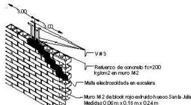
Detalle de Muro M-2
