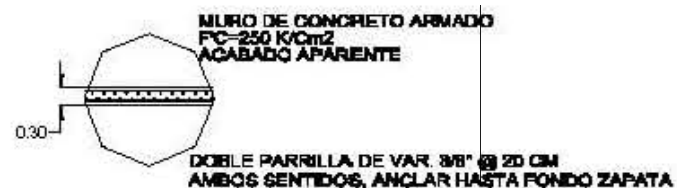
M-1 Muro M-1 de concreto armado f_c=250 kg/cm 2
