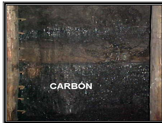
Fotografía 3.2. Detalle donde se observa el combustible en fase sólida (carbón) en proceso de combustión originado por el oxidante. (Fuente: Mina III - MIMOSA).
