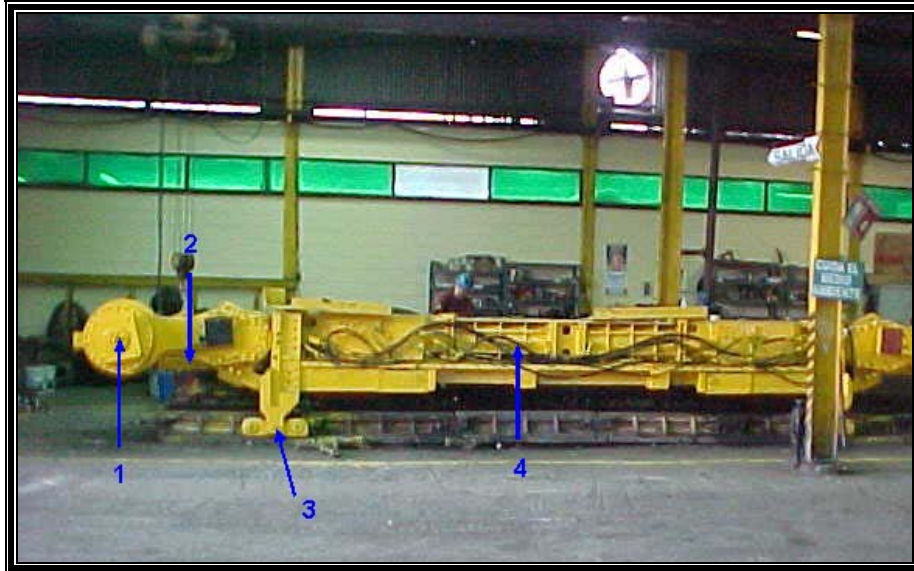
Fotografía 6.1. Rozadora: 1) actuadores de los deflectores, 2) motor de corte, 3) zapato de agarre, 4) caja de controles y abajo se observa bastidor blindado. (Fuente: Mina III – MIMOSA).
