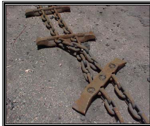
Fotografía 6.7. Detalle de las rejetas del transportador blindado.
