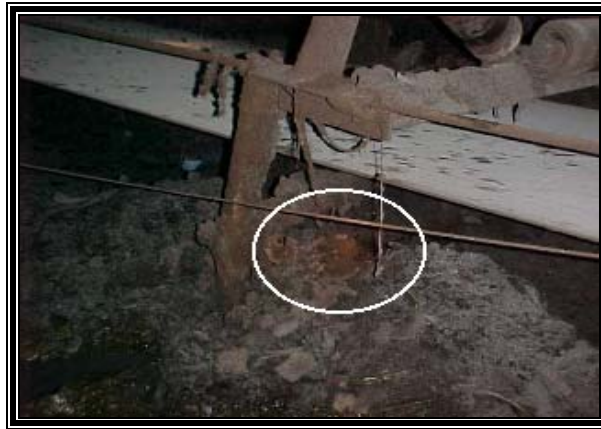
Fotografía 3.1. Riesgo de autocalentamiento de un carbón en contacto directo con la atmósfera. (Fuente: Mina III - MIMOSA).
