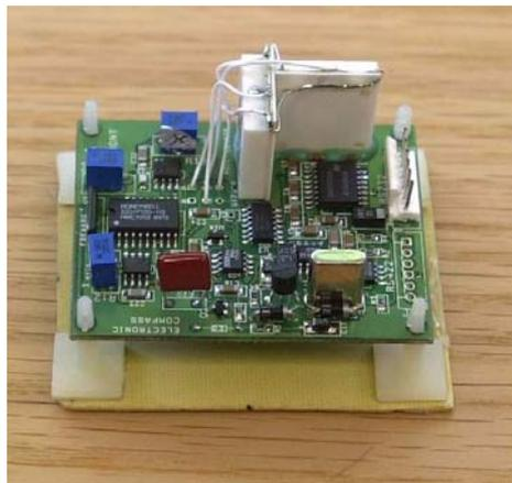
*Figura 1.8. Brújula electrónica dotada con dos inclinómetros.*
