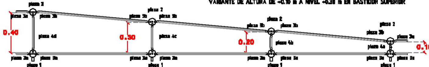
VARIANTE DE ALTURA DE +0.10 m A NIVEL MÁXIMO +0.40 m EN BASTIDOR SUPERIOR
